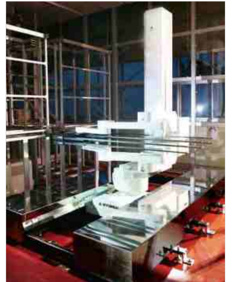
현대중공업이 생산한 LCD 운반용 로봇
