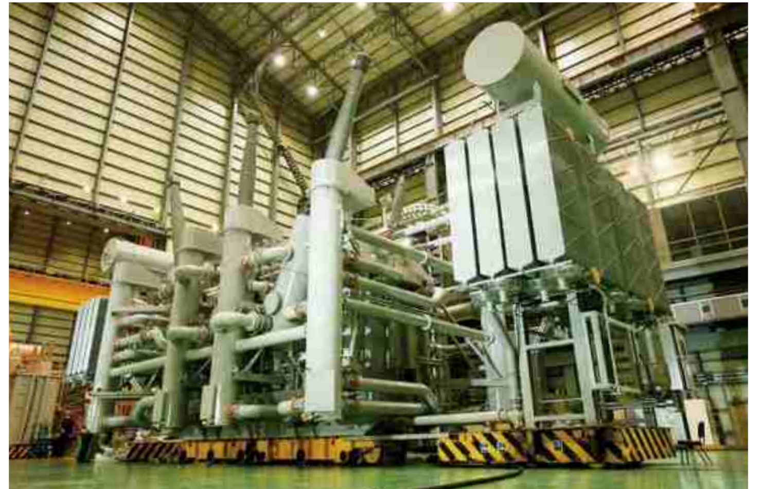
현대중공업이 생산한 충격 흡수용 변압기
