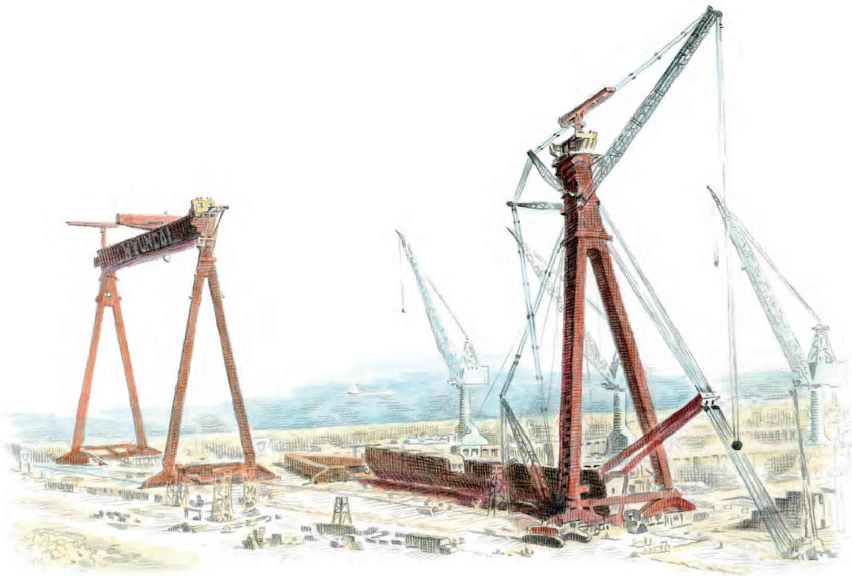
도크(Dock)를 한자로는 '선거(船渠)'라고 하는데, 배를 만드는 것뿐만 아니라 완성된 배를 처음 물에 띄우는 것도 바로 이곳에서 이뤄진다. 도크가 배를 탄생시키는 자궁(子宮)이라고 불리는 이유다. 형태에 따라 '드라이 도크'와 '플로팅 도크'로 나뉘는데 일상적으로 도크는 드라이 도크를 의미한다. 드라이 도크는 바다를 수문으로 차단하고 웅덩이처럼 깊게 판 형태로, 초대형 육조나 수영장을 연상하면 된다. 배가 완성되면 도크에 물을 채워 쉽게 바다로 빼내는 용도다.
